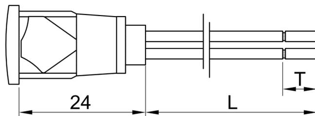
**Segnalatore luminoso a LED con innesto da fronte pannello autobloccante, con testa sottile (spessore 2,5mm)**
